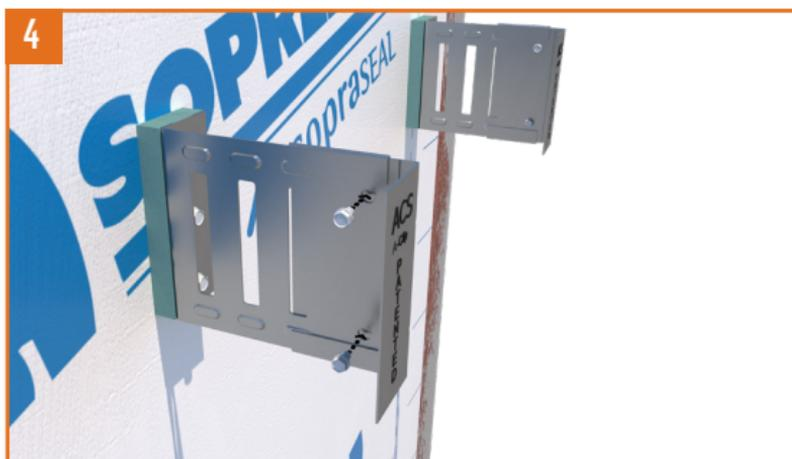
4 Serrez et fixez les deux pièces ensemble en utilisant les vis fournies avec les Attaches Thermique ACS.
